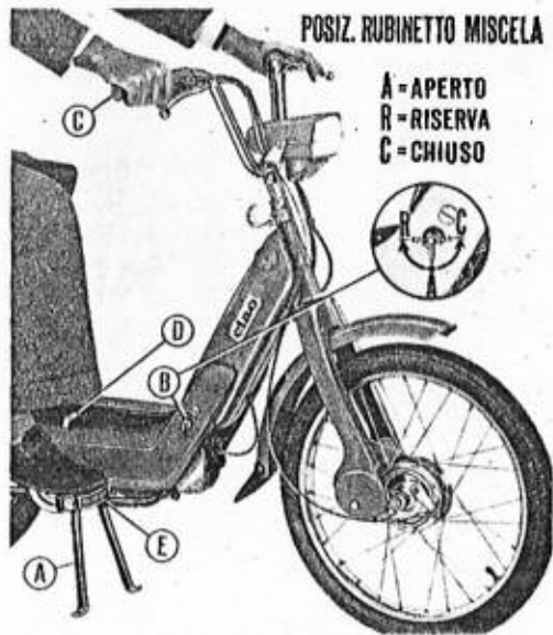
Fig. 4 - Operations for starting - Opérations pour la mise en marche - Operaciones para el arranque.
