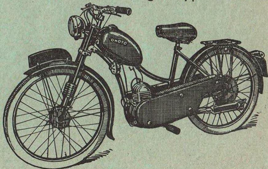
Moteur " LAVALETTE " 70,5 cm<sup>3</sup>; trois vitesses; mise en route par kick; roues et pneus de 600 × 55 C; fourche télescopique; deux freins tambour grand diamètre; vitesse 70 km/h. Ce modèle peut être livré avec cadre homme (genre moto).
