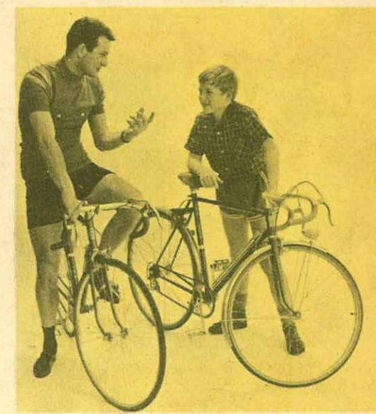
Toutes nos bicyclettes "SPORT" et "COURSE" sont montées avec cadre de 56 cm. Moyeux indérégables à petits corps. Écrous à oreilles. Dérailleurs "Simplex". Freins en alliage léger à haute résistance avec détendeur instantané. Chromage de luxe. Nuances au choix, suivant modèle, laquées au four sur antirouille. Selle croupon. Accessoires de choix.
