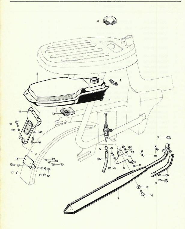
FUEL TANK - MUFFLER Exhaust - TAILLIGHT STAY
