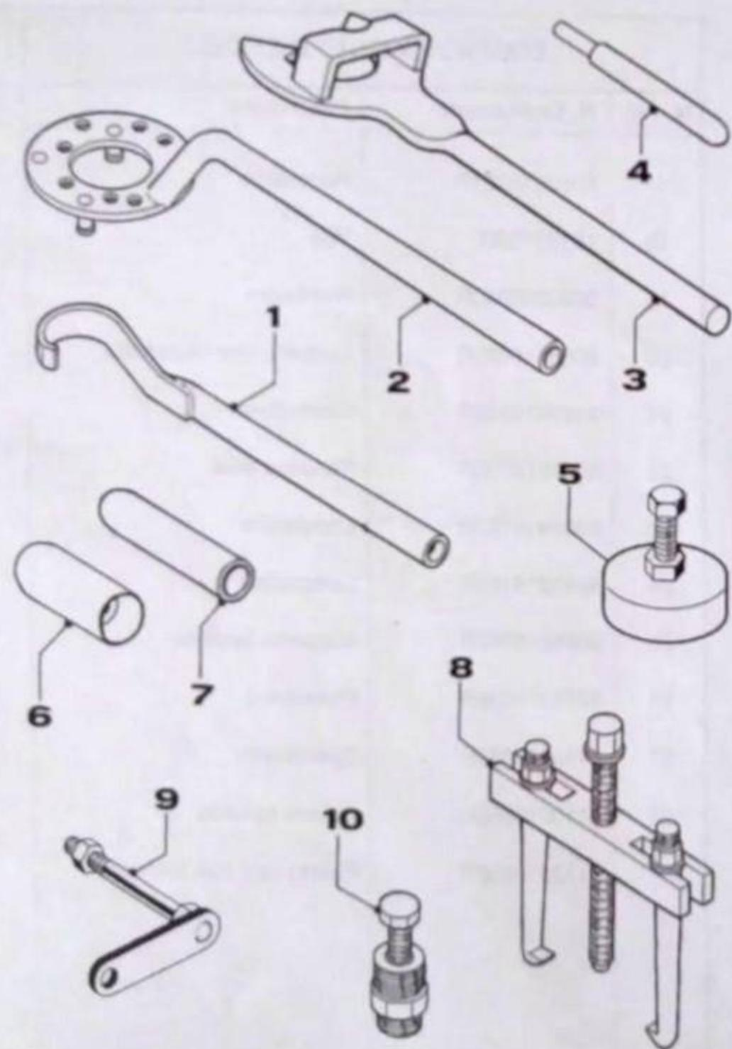
ATTREZZI SPECIALI SMONTAGGIO E MONTAGGIO MOTORE
