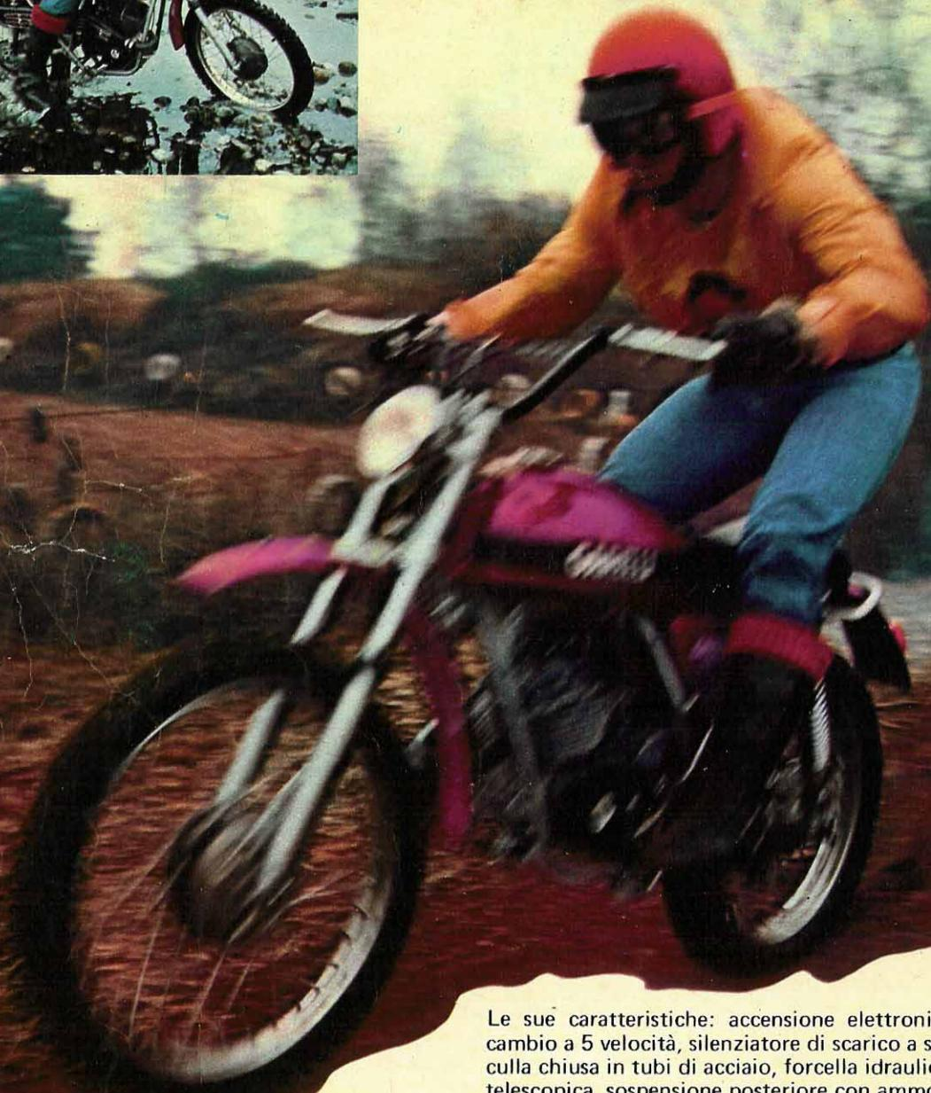
Le sue caratteristiche: accensione elettronica, cilindrata 49 cc., cambio a 5 velocità, silenziatore di scarico a sogliola, telaio a doppia culla chiusa in tubi di acciaio, forcella idraulica telescopica, sospensione posteriore con ammortizzatori idraulici regolabili su tre posizioni. Garelli è anche una gamma completa di ciclomotori per tutte le esigenze: Junior GT, Gulp, Eureka e Katia.
