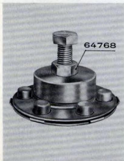
Fig. 5 - Smontaggio della frizione
