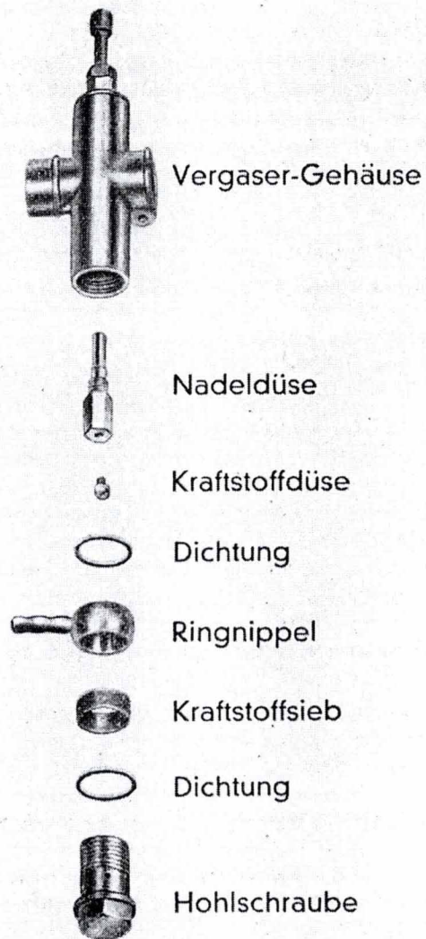
5. Vergaser in seiner Zusammensetzung
