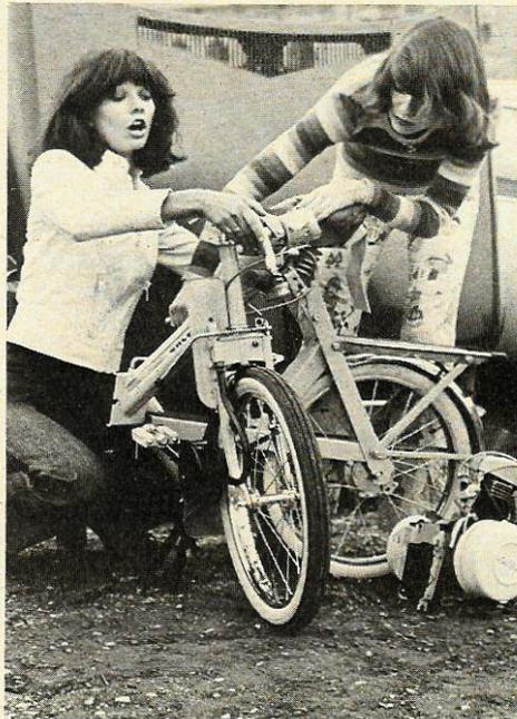
rapide, selle repliable à accrochage et serrage rapide et cadre pliable par charnière à blocage tout aussi rapide. Le 5000 ainsi plié n'occupe plus que 0,85 m sur la hauteur, 0,50 m sur la largeur et 0,83 m sur la longueur. Si on se souvient que le 5000 ne pèse que 28 kg on se rend compte que sa taille et son poids sont à peu près comparables à ceux d'une malle. Ses utilisations sont multiples.
